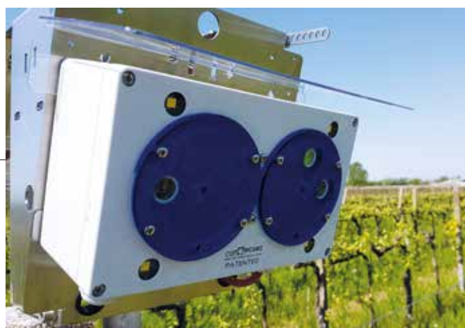
Fig. 1 - Un innovativo dispositivo di visione artificiale raccoglie immagini 3D della chioma utili per la stima dello stato idrico della vite (foto: Copyright CET Electronics).
